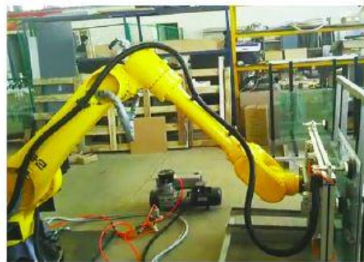
机器人应用于玻璃切割机上下玻璃料 Robot used in the loading & unloading cell for glass panels
