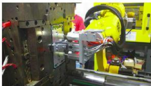
手机外壳预热——注塑——上下料工作站 Robot loading & unloading cell for injection molding machine
